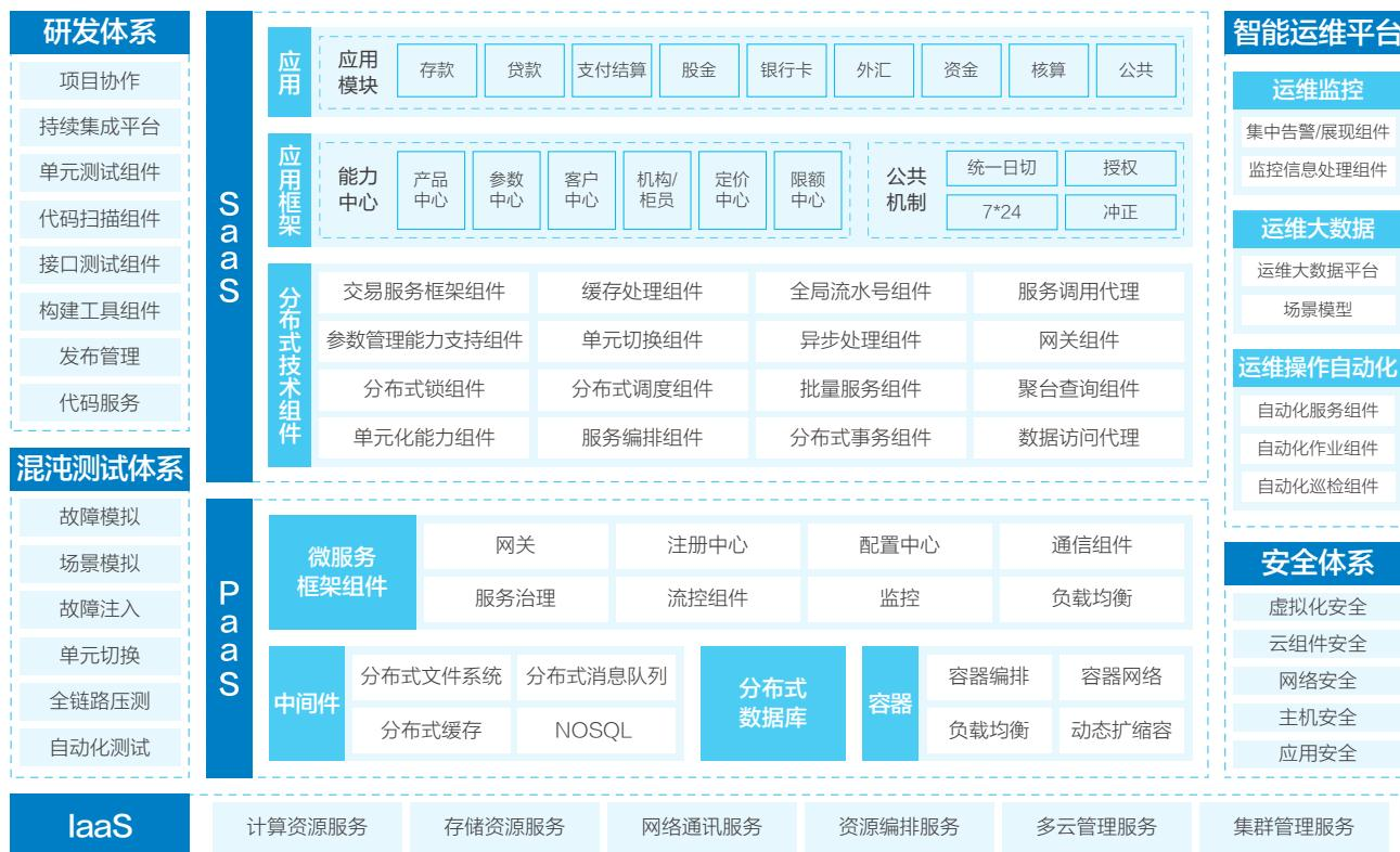
如上图所示，整体架构可分为七大部分内容。底层是IaaS云平台，中间是PaaS云原生平台，上层是SaaS核心应用领域，左侧为研发效能体系和混沌测试体系，右侧为智能运维体系和安全体系。上图七块内容形成新核心所需的整体能力框架。
