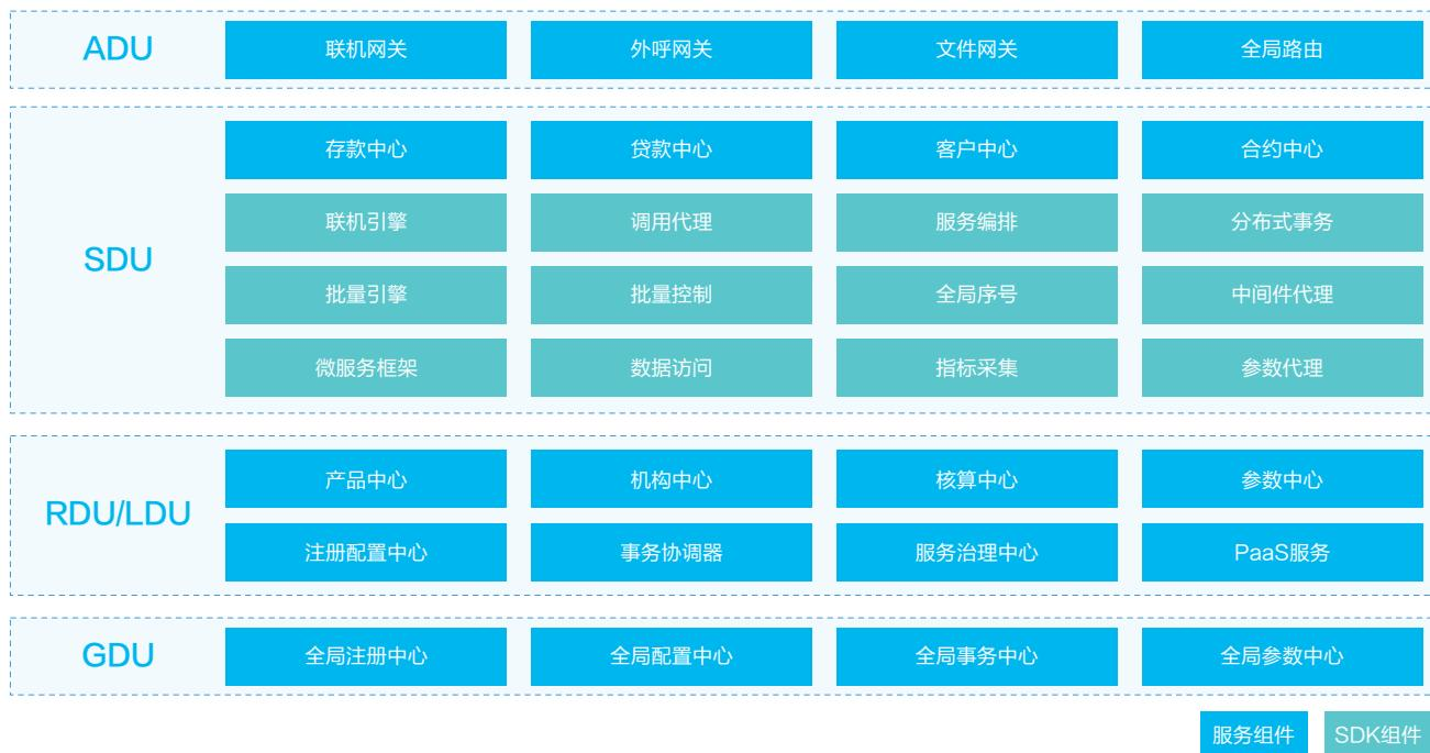
站在整体核心系统应用视角，根据应用服务特征归纳形成多种单元类型。将单元以业务处理顺序的维度进行分解，形成：接入单元(ADU)负责接入接出能力、标准处理单元(SDU)负责业务处理能力、本地单元(LDU)和同城单元(RDU)分别用于提供单AZ共享服务能力和同城共享服务能力、以及在异地多活架构中会涉及的全局类型服务则由全局单元(GDU)提供。
