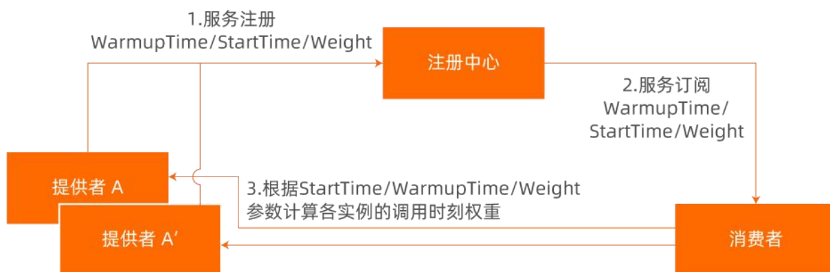
图 7 应用小流量预热过程原理图
